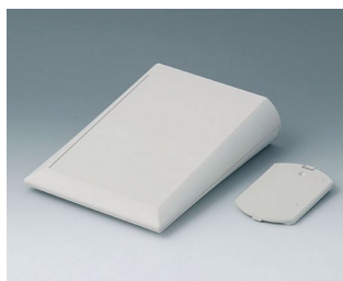
A0615017 COMTEC 150 F, исп. II АБС (UL 94 HB) белый RAL 9002 150x200x51,5mm IP 40
