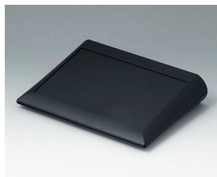
A0620009 COMTEC 200 F, исп. I АБС (UL 94 HB) черный RAL 9005 200x150x42,8mm IP 40
