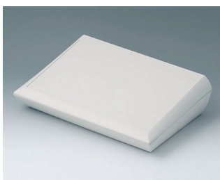
A0629107 COMTEC 290 H, исп. I АБС (UL 94 HB) белый RAL 9002 290x200x75,5mm IP 40
