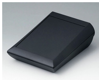
A0615109 COMTEC 150 H, исп. I АБС (UL 94 HB) черный RAL 9005 150x200x71,5mm IP 40
