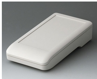
A9006107 DATEC-COMPACT M ACA+ПК-ФР (UL 94 V-0) белый RAL 9002 172x92x39mm IP 65
