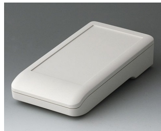
A9006117 DATEC-COMPACT M ACA+ПК-ФР (UL 94 V-0) белый RAL 9002 172x92x39mm IP 41
