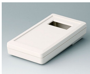
A9073217 DATEC-MOBIL-BOX S, исп. II АБС (UL 94 HB) белый RAL 9002 152x83x33,5mm IP 65 opt.
