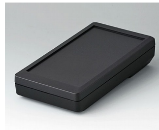
A9073119 DATEC-MOBIL-BOX S, исп. I АБС (UL 94 HB) черный RAL 9005 152x83x33,5mm IP 65 opt.
