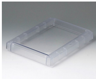
B4016621 Крышка М, низкая ПК (UL 94 V-0) прозрачный 168x220x29mm
