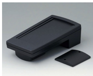
A9046109 HAND-TERMINAL M, исп. I ПК+АБС (UL 94 V-0) черный RAL 9005 220x120x65mm IP 65 opt.
