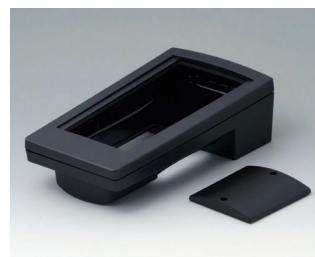
A9046209 HAND-TERMINAL M, исп. II ПК+АБС (UL 94 V-0) черный RAL 9005 220x120x65mm IP 65 opt.
