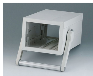
B2212317 MEDITEC E 220, с ручкой АБС (UL 94 HB) белый RAL 9002 160x260x124mm IP 40
