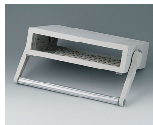
B2211117 MEDITEC D 160, с ручкой АБС (UL 94 HB) белый RAL 9002 290x200x74mm IP 40
