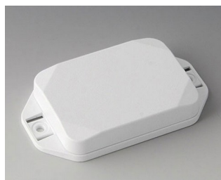
B1824127 MINI-DATA-BOX EF50, плоский, с ушками АСА+ПК (UL 94 V-0) белый RAL 9016 70x50x15mm IP 65 opt., IP 40
