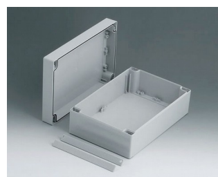
C2116242 ROBUST-BOX с шириной 160, исп. II ПК (UL 94 HB) светло-серый RAL 7035 240x160x90mm IP 66
