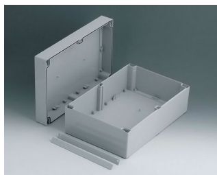
C2420301 ROBUST-BOX с шириной 200, исп. I АБС (UL 94 HB) светло-серый RAL 7035 300x200x120mm IP 66
