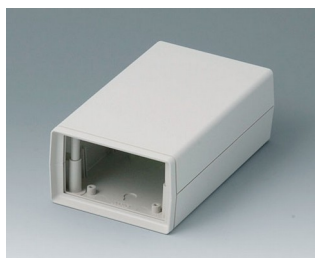
A9408440 SHELL-TYPE CASE O 155, исп. I ABC (UL 94 HB) белый RAL 9002 95x155x57mm
