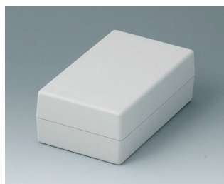
A9408441 SHELL-TYPE CASE G 155, исп. I ABC (UL 94 HB) белый RAL 9002 95x158x57mm IP 65 opt.
