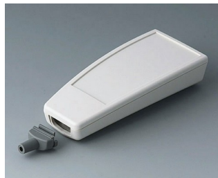
A9067127 SMART-CASE L, исп. III АБС (UL 94 HB) белый RAL 9002 140x62,7x30,5mm IP 65 opt.
