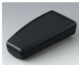
A9066119 SMART-CASE M, исп. II АБС (UL 94 HB) черный RAL 9005 96x47x24mm IP 40
