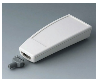
A9067147 SMART-CASE L, исп. V АБС (UL 94 HB) белый RAL 9002 140x62,7x30,5mm IP 65 opt.
