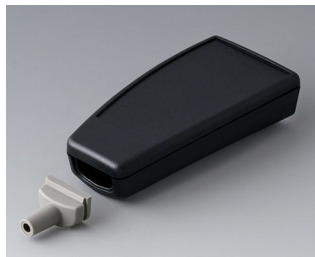
A9066129 SMART-CASE M, исп. III АБС (UL 94 HB) черный RAL 9005 96x47x24mm IP 40
