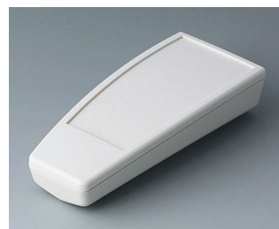
A9067117 SMART-CASE L, исп. II АБС (UL 94 HB) белый RAL 9002 140x62,7x30,5mm IP 65 opt.
