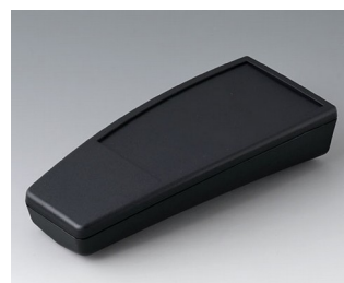
A9068219 SMART-CASE XL, исп. II ПММА (ИК) (UL 94 HB) черный RAL 9005 168x74,4x35,4mm IP 65 opt.
