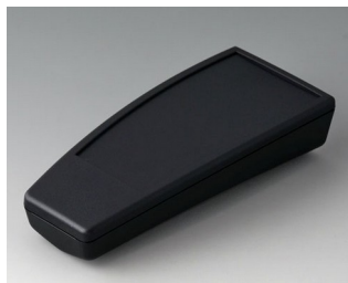
A9067219 SMART-CASE L, исп. II ПММА (ИК) (UL 94 HB) черный RAL 9005 140x62,7x30,5mm IP 65 opt.
