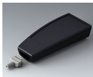
A9067149 SMART-CASE L, исп. V АБС (UL 94 HB) черный RAL 9005 140x62,7x30,5mm IP 65 opt.
