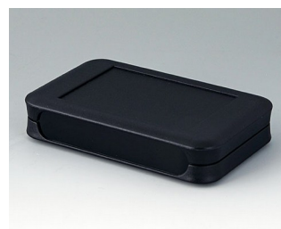
A9052209 SOFT-CASE L ПММА (ИК) (UL 94 HB) черный RAL 9005 73x117x24mm IP 54 opt.
