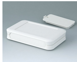
A9052117 SOFT-CASE L АБС (UL 94 HB) белый RAL 9002 73x117x24mm IP 40
