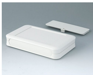
A9053117 SOFT-CASE XL АБС (UL 94 HB) белый RAL 9002 92x150x28mm IP 40
