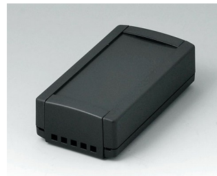
B1040469 TOPTEC 102, исп. II АБС (UL 94 HB) черный RAL 9005 102x54x30mm IP 40
