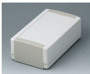
B1070365 TOPTEC 194 H, исп. I АБС (UL 94 HB) белый RAL 9002 194x115x68mm IP 40
