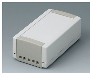
B1050465 TOPTEC 123 H, исп. II АБС (UL 94 HB) белый RAL 9002 123x68x45mm IP 40
