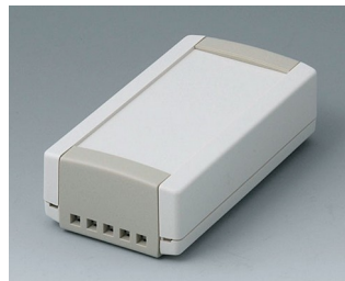
B1040465 TOPTEC 102, исп. II АБС (UL 94 HB) белый RAL 9002 102x54x30mm IP 40
