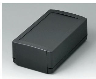
B1070369 TOPTEC 194 H, исп. I АБС (UL 94 HB) черный RAL 9005 194x115x68mm IP 40
